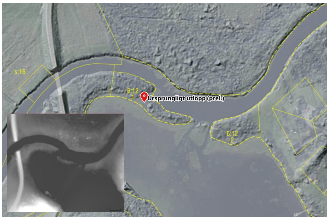
Figur 26: Det ursprungliga utloppet låg sannolikt väster om nuvarande sjöutlopp. Karta från lantmäteriets webb "minkarta". (c) Lantmäteriet. Infälld höjdmodell baseras på höjddata vid vattenståndet 44,7 m då vattnet då flödade även genom den västra kanalen (källa: Lantmäteriets "Markhöjdmodell Nedladdning" med licensen CC-BY 4.0)
