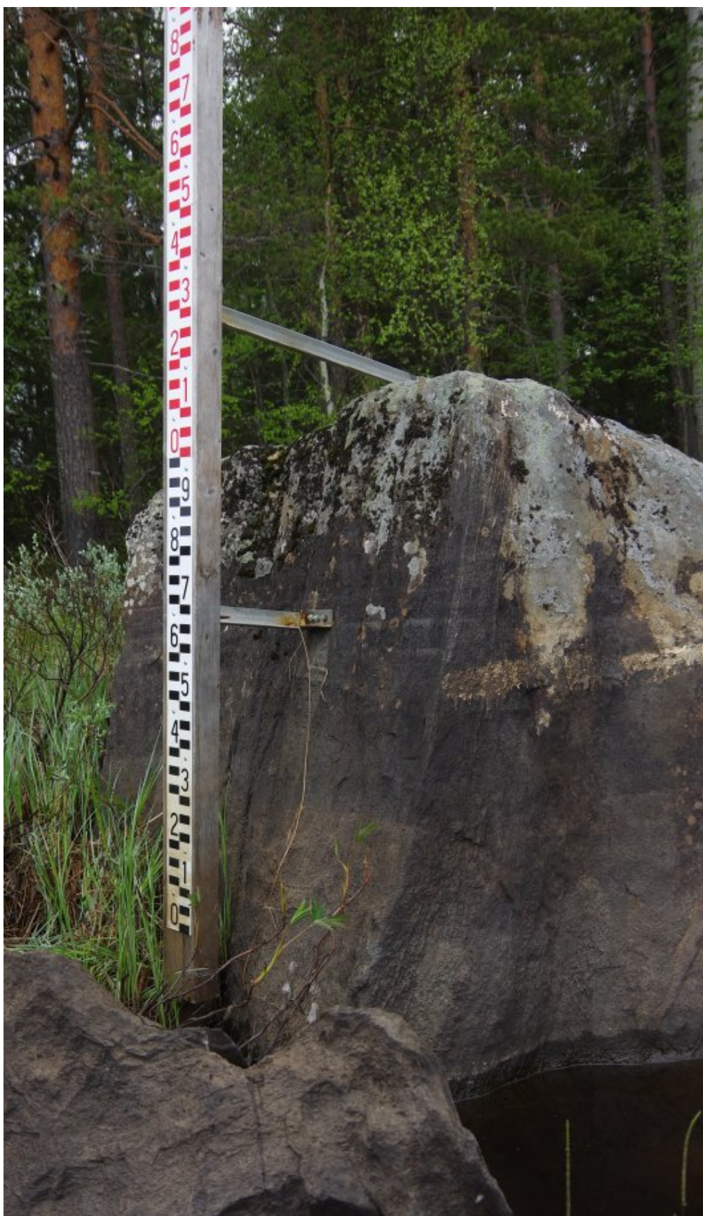
Figur 20: Peglen på Fårön har tryckts uppåt av isen. På ovansidan av blocket finns dubben.
