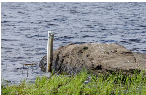
Figur 11: Loggerröret i Fäbodträsket strax efter installation den 28 maj.
