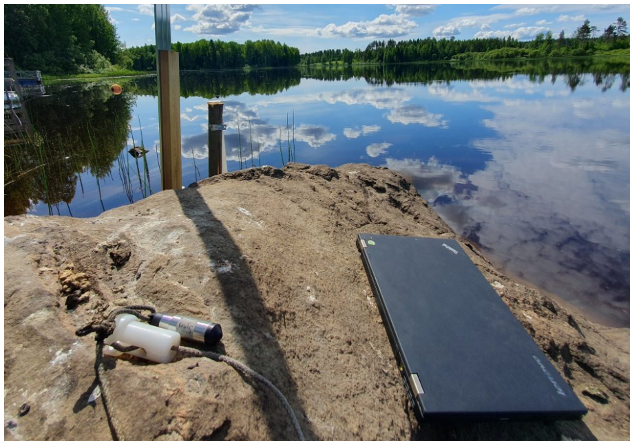
Figur 2: Loggrarna anslöts optiskt mot dator. I bilden visas loggerkontrollen som gjordes den 13 juni vid Fäbodträsket. Divern ligger nere till vänster i bild.
