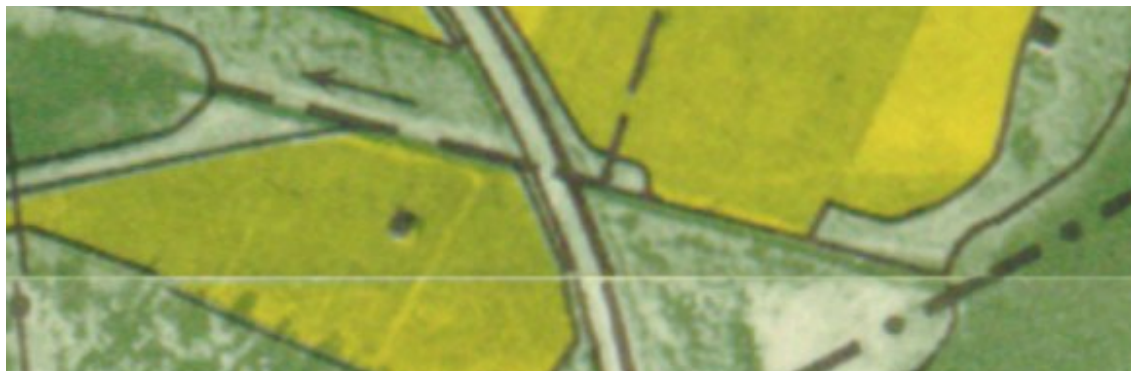
Figur 47. På flygbilden daterad 1954-06-15 syns att kanalen har en rak och bred form och att den kantas av ljus färgad jord – som indikerar relativt nyligt upplagda rensningsmassor.
