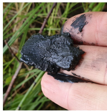
Figur 13: På mjuka bottenar i Högfjärden ligger den potentiellt sura sulfatjorden ytligt. Här ett stickprov direkt vid stranden nedanför Månberget. Denna typ av potentiellt sur sulfatjord kallas "svartmucka" och får sin färg från järnmonosulfid ( \text{FeS} ). Foto: Jan Åberg 2024.
