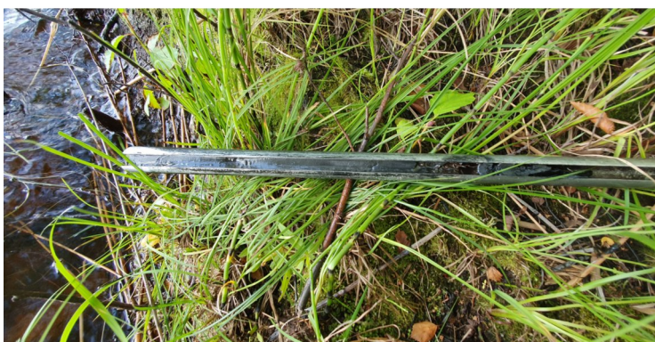
Figur 13: På mjuka bottenar i Högfjärden ligger den potentiellt sura sulfatjorden ytligt. Här ett stickprov direkt vid stranden nedanför Månberget. Denna typ av potentiellt sur sulfatjord kallas "svartmucka" och får sin färg från järnmonosulfid ( \text{FeS} ). Foto: Jan Åberg 2024.
