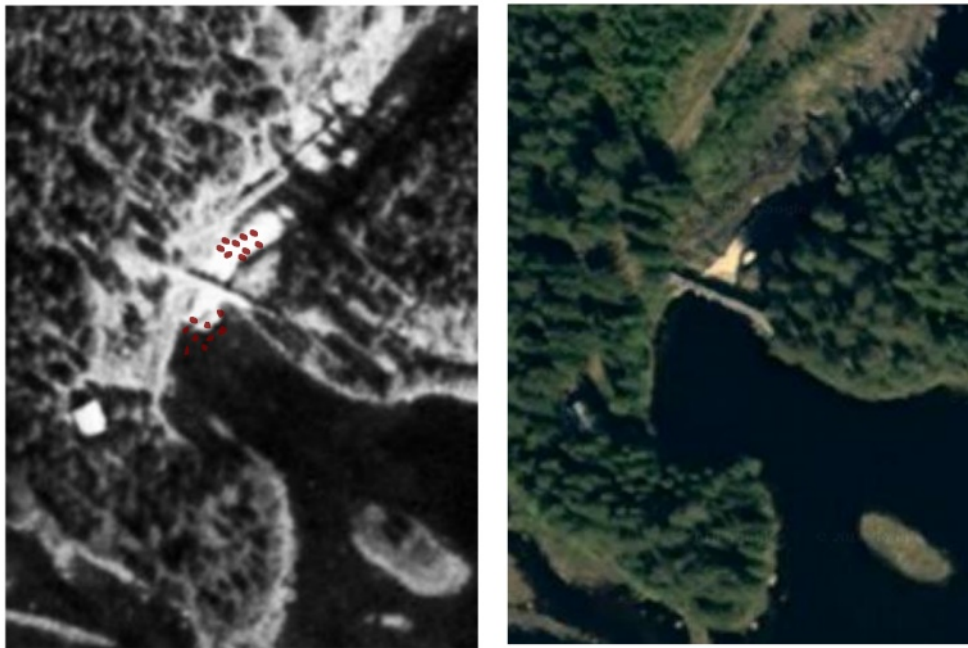
Figur 4: Om betonghindret i Åselestupets översta del ta bort kan forsen åter bli vandringbar. Flygbilden till vänster visar att den övre nacken var mycket längre (och flackare) innan bygget av Äglunds kraftverk. Bilden till höger visar läget efter bygget av Äglund. Flygbilder © Lantmäteriet.
