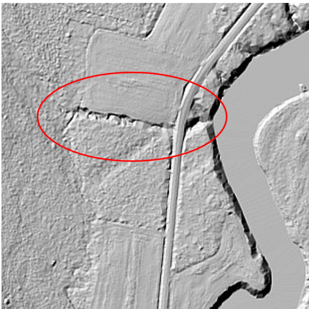
Figur 39: Ravinen som bildats genom Tyrildsjöbäckens avgrävning. Här pågår aktiv erosion som successivt ökat risken för skred från åkermarken ner i ravinen. Terrängskuggning: © Lantmäteriet.
