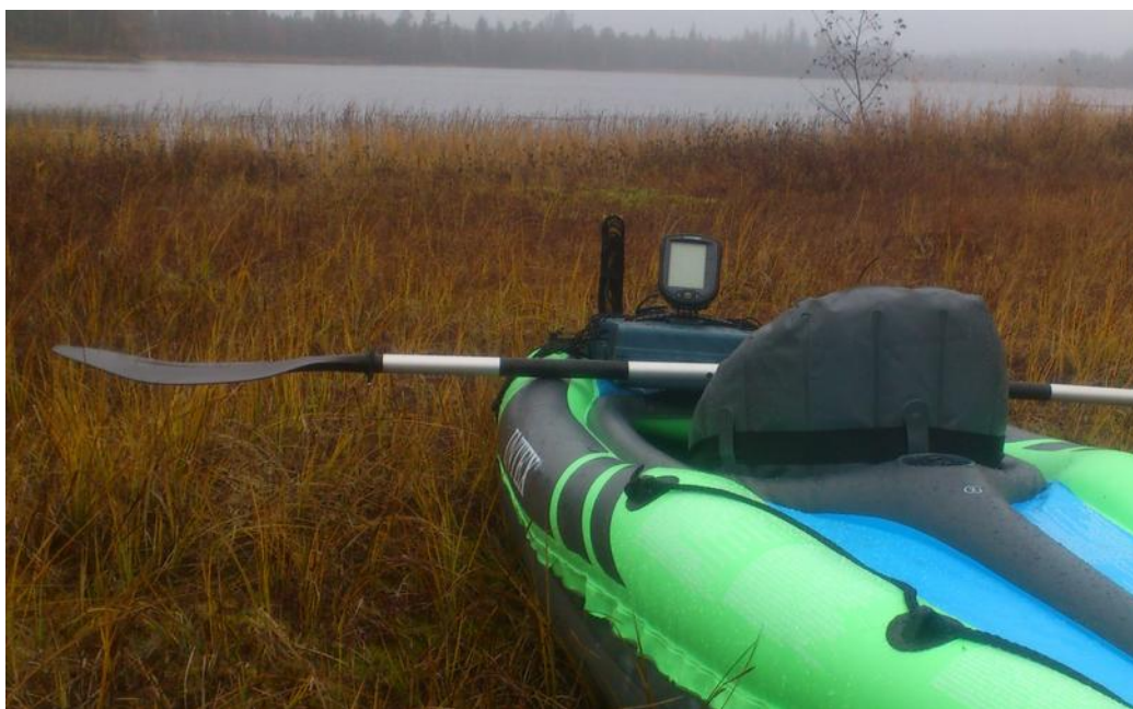
Figur 1: Portabel utrustning för djupkartering användes, för att kunna nå även sjöar långt från närmaste väg. Bilden är från tillfället då Marragrundsfjärden karterades.
